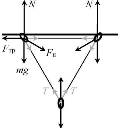
На каждое из верхних колец помимо силы со стороны нити и силы тяжести действуют также силы со стороны спицы — сила реакции  $N$ , направленная вверх, и сила трения  $F_{tp}$ , направленная горизонтально вдоль спицы. Запишем равенство внешних сил, действующих на систему из нити и трёх колец, в проекции на вертикальную ось (внутренние силы натяжения можно при этом не учитывать):
