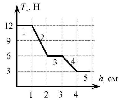
На участке 1 сила натяжения нити  $T_1 = 12$  Н равна сумме весов верхнего  $P_1$  и нижнего  $P_2$  грузов:
