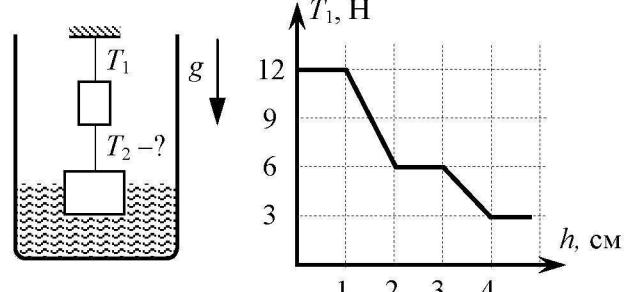
Определите силу натяжения  $T_2$  нижней нити в момент, когда вода скроет нижний груз.
