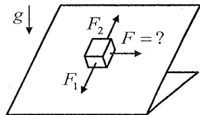
**Решение.** Поскольку силы  $F_1$ ,  $F_2$  и  $F$  действуют вдоль наклонной плоскости, то сила реакции опоры  $N$ , и соответственно, сила трения при движении тела  $F_{mp} = \mu N$  будет одинаковой во всех трёх случаях. Чтобы сдвинуть тело, необходимо преодолеть силу трения, действующую на тело. Пусть  $\alpha$  — угол наклона плоскости,  $m$  — масса тела. Уравнения равновесия тела при воздействии сил  $F_1$  и  $F_2$  имеют вид:
