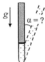
**Решение.** Найдём положение равновесия поршня, когда пробирка отклонена на угол  $\alpha$  от вертикали. Согласно закону Бойля-Мариотта ( $PV = \text{const}$ ),
