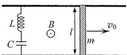
Вертикально приложено однородное магнитное поле с индукцией  $B$ . Пренебрегая сопротивлением перемычки и рельсов, найти максимальный ток  $I_m$  в цепи.
