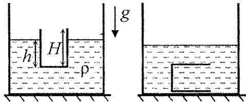
**Решение.** Когда стакан плавает, сила тяжести  $mg$  и сила Архимеда  $\rho g Sh$  (где  $S = V/H$  — площадь сечения стакана) уравновешивают друг друга:
