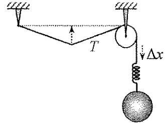
В обоих случаях перемещение  $\Delta x$  одинаково, т. к. оно задаётся оттягиванием нити. Сравним теперь натяжение нити с пружиной и без пружины.
