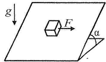
**Решение.** Тело движется под некоторым углом к склону, в направлении результирующей силы  $F$  и составляющей силы тяжести вдоль наклонной плоскости  $mg \sin \alpha$ . Направление силы трения противоположно направлению движения тела, а значит, и направлению ускорения. Уравнение движения тела имеет вид:
